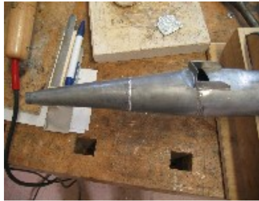
der angelötete und ausgeformte Pfeifenfuß
