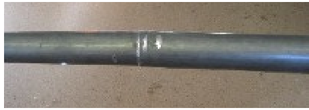
die wieder zusammengesetzte ausgerundete Salicionalpfeife
