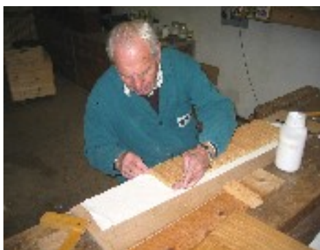
Vater beim beledern der Ventile
