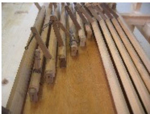
die reparaturbedürftigen Stellen am Pedalwellenbrett
