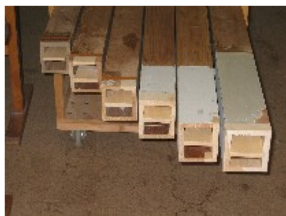
die ausgeglichenen Pfeifenmündungen mit neuen Stimmhölzern
