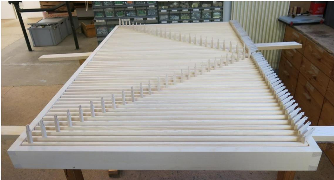
*der Wellenrahmen aus Fichte liegt direkt unter der Positivlade*
