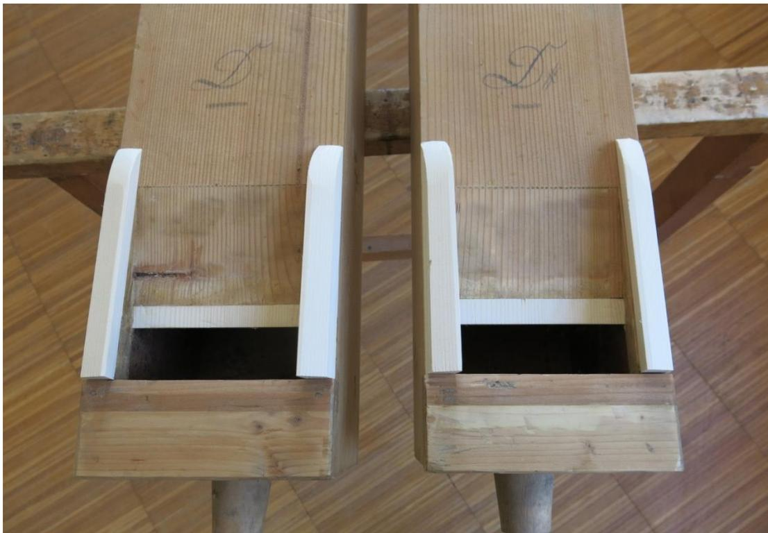
*...daher wurden diese mit Holz abgesenkt und so ist eine stabile Intonation möglich*
