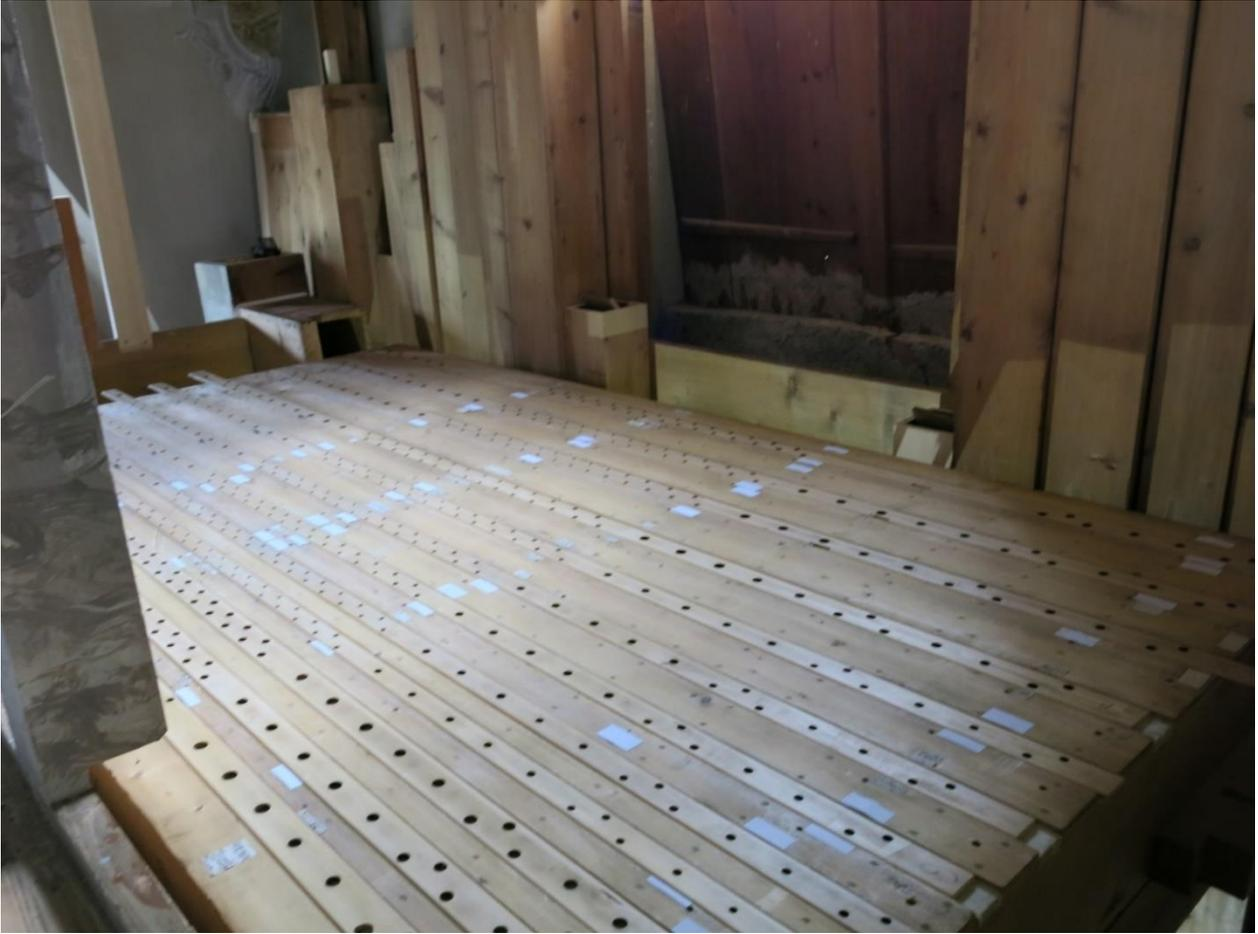
*die eingebaute Hauptwerkklade ohne Stöcke*
