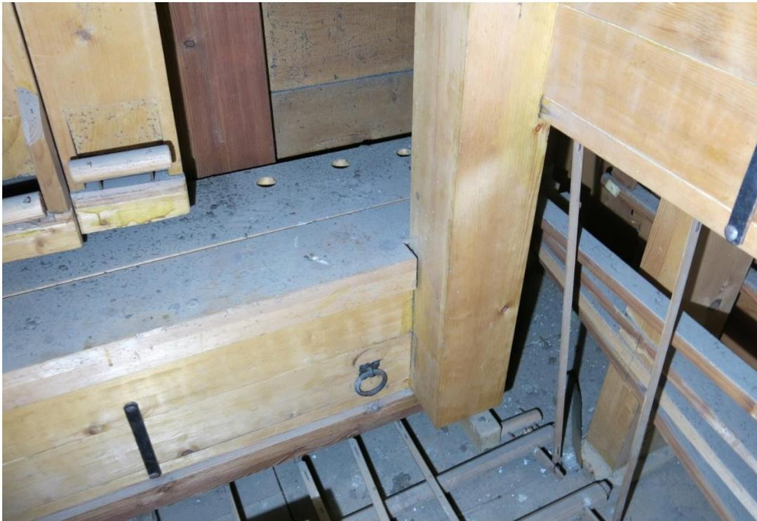
die Pedallade steht direkt auf dem Boden beziehungsweise seitlich auf Sturz etwas erhöht
