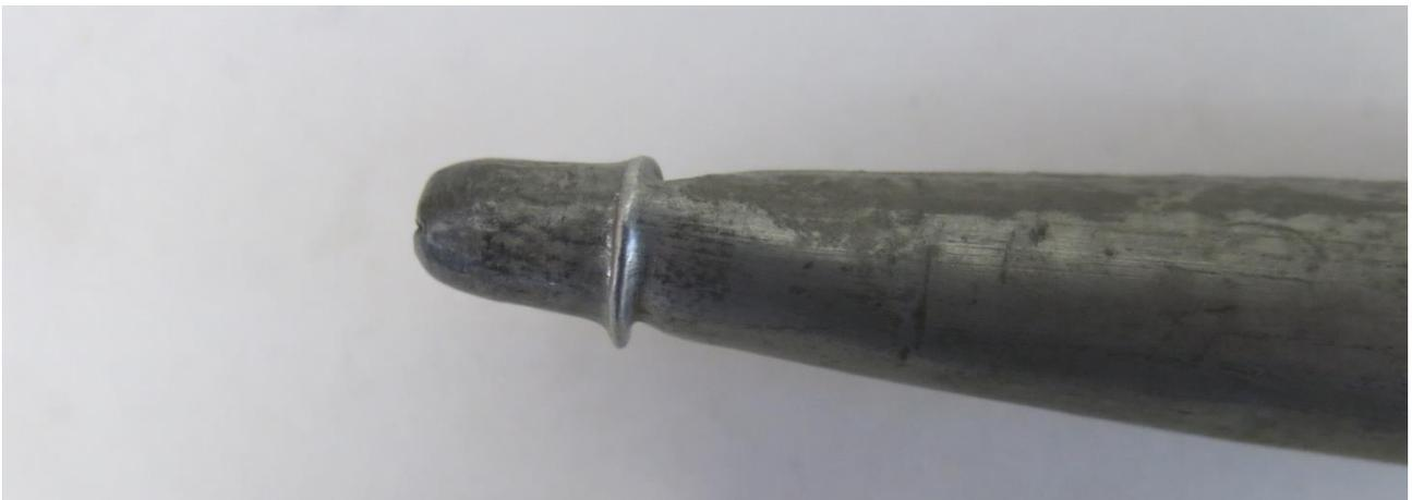
*ingesunkene Fußspitzen wurden ausgetrieben und bei zu schwachem Material erneuert*
