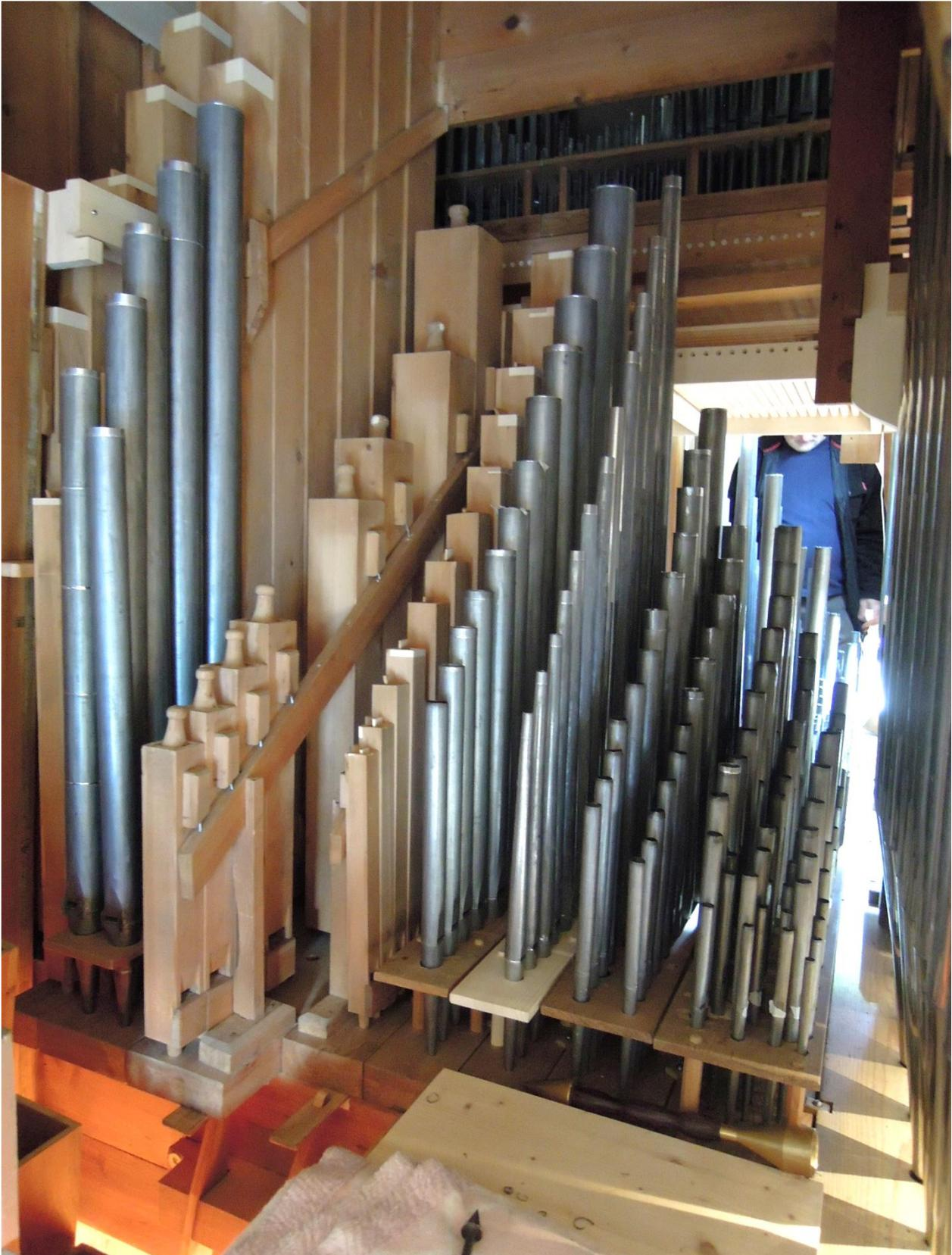
*das fast fertig montierte Pfeifenwerk*
