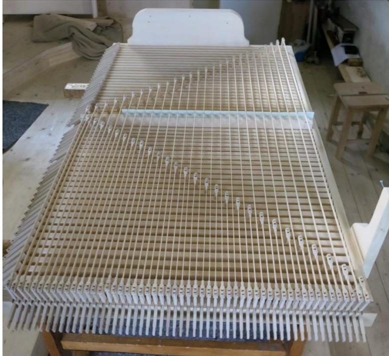
*das vormontierte Wellenbrett, bereit zum Einbau*
