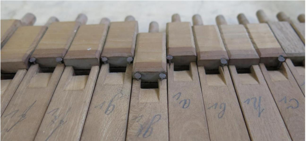
*bei Flöte 4' waren sämtliche Vorschläge abgesprungen und mit Nägeln fixiert,*
